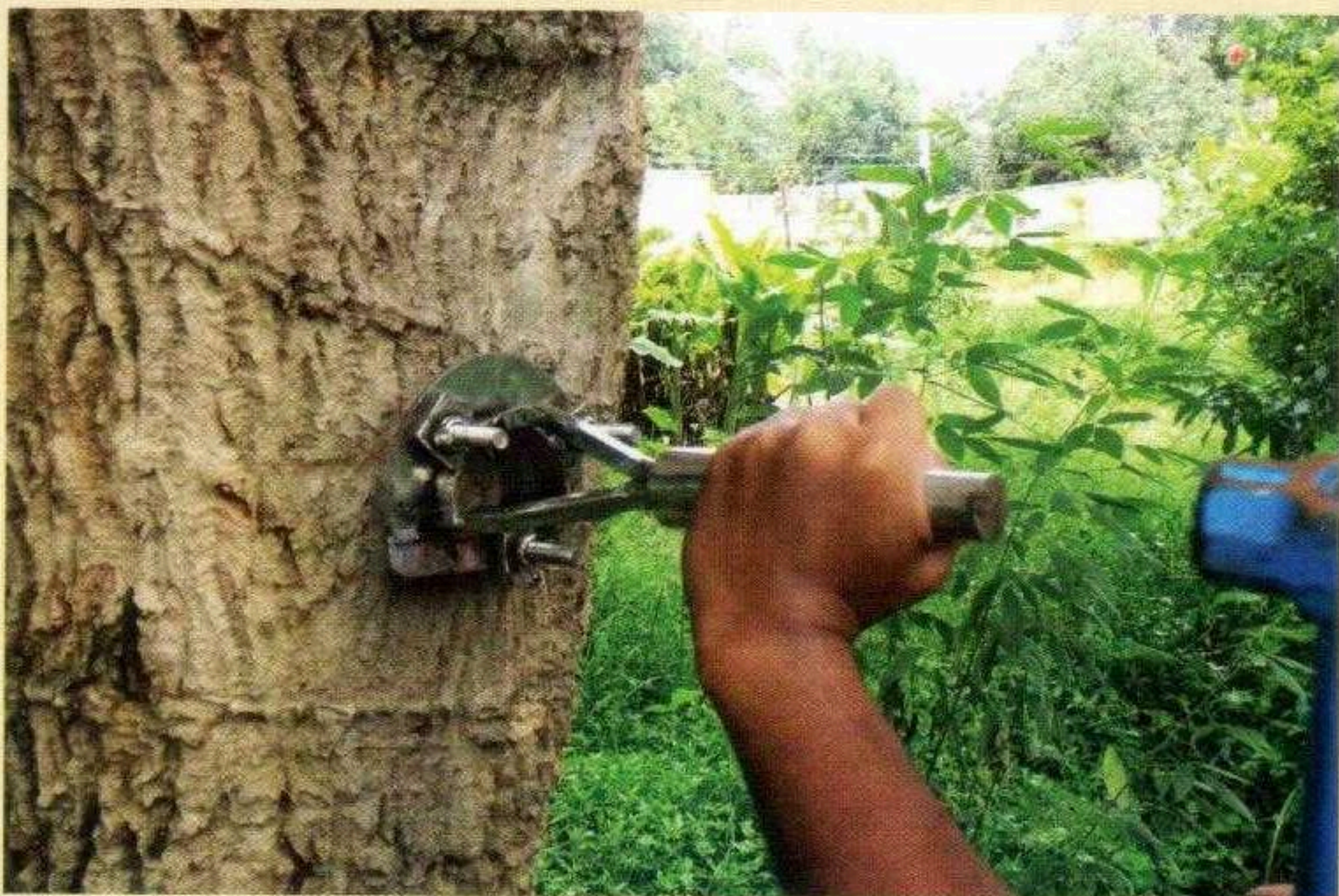
चित्र 3: हस्त चालित पोर्टेबल ब्लेजर के द्वारा ब्लेज विकसित करना
